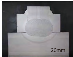
高性能溶接材料を適用した 超大入熱エレクトロスラグ溶接部と溶接金属ミクロ組織
